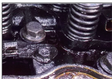
シリンダーヘッド上部バルブ周辺部 がヘドロ状になったオイルで固着
