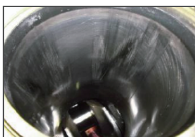
※1 潤滑不良によりスカッフ を起こした シリンダーライナー
